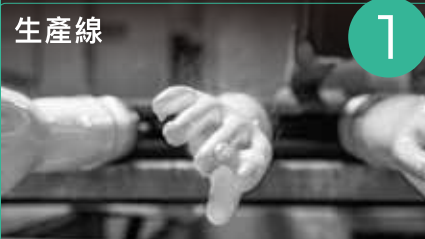
生產線 1 使用天然乳膠原料，多次浸泡手模，強化手套韌性及耐用度，增強手套防護力
